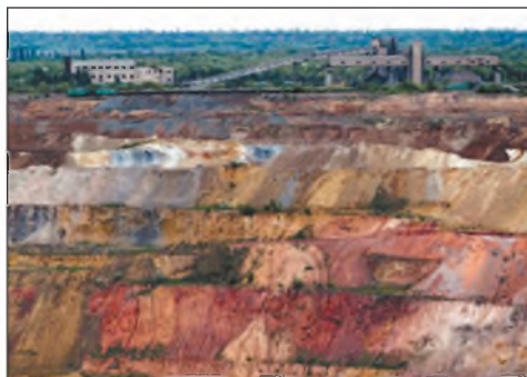
Мал. 3. Залізорудний кар'єр Південного гірничозбагачувального комбінату в Кривому Розі: довжина — 3 км, глибина — до 400 м.
