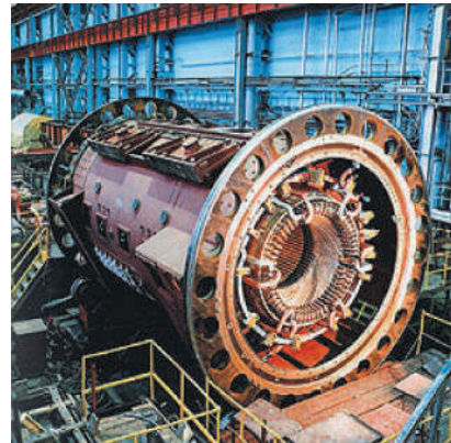
Рис. 25.2. Завдяки турбогенераторам, що перетворюють механічну енергію обертання турбін на енергію електричного струму, виробляють 80% споживаної у світі електроенергії
