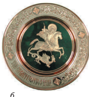
Рис. 38.4. Отримання рельєфних копій за допомогою електролізу: а — схема пристрою: восковий зліпок, покритий тонким шаром графіту, є катодом (1), срібна пластинка — анодом (2); ванна наповнена розчином нітрату срібла; б — одержана копія
