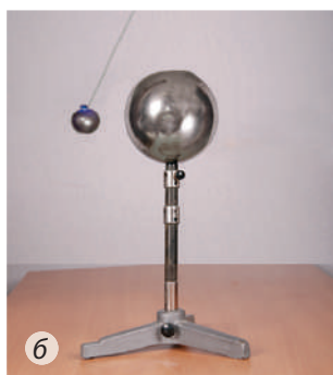
Рис. 21.3. Електризація сфери через вплив (а); індикатором наявності заряду слугує позитивно заряджена повітряна кулька — вона відхиляється від сфери, отже, сфера (на відміну від палички) заряджена позитивно (б)
