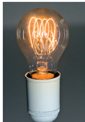
Рис. 35.3. Нагрівальний елемент електричної лампи розжарення виготовляють із вольфраму, температура плавлення якого 3387 °С. Нагріваючись до температури 3000 °С, тонка вольфрамова нитка починає яскраво світитися
