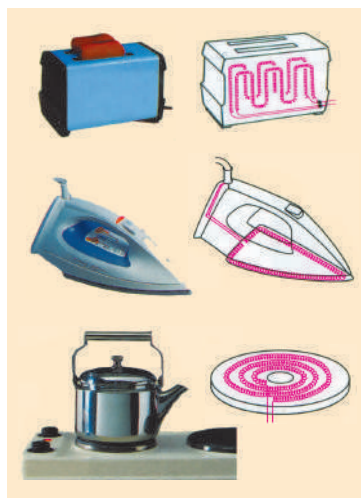
Рис. 35.2. Основна частина будь-якого електричного нагрівального пристрою — нагрівальний елемент
